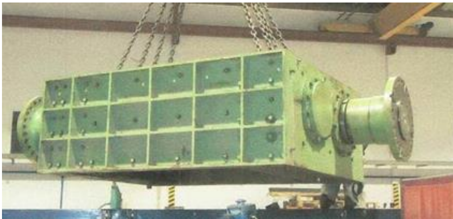
Fotografia 1. Màquina trituradora pneumàtica de doble eix
