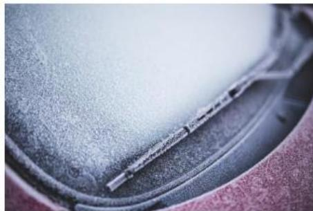
Recuerda que **jamás se deben activar las escobillas si el parabrisas está congelado o hay mucha nieve sobre él**, puesto que se dañarían las propias escobillas o el motor del limpiaparabrisas al atascarse o pegarse por culpa del hielo o la nieve.
