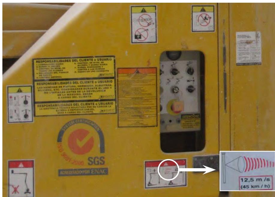
Señalizaciones en PEMP, incluida máx. velocidad de viento, cuyo detalle se resalta en la imagen. INVASSAT
