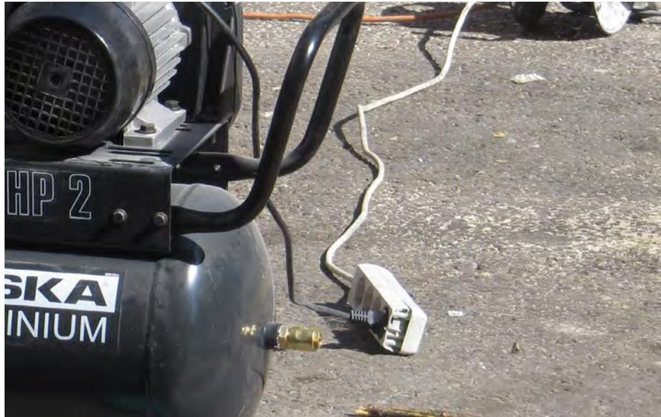
Los grados de protección mínimos para las canalizaciones y envoltentes será IP 45 al tratarse de instalaciones de exterior.
