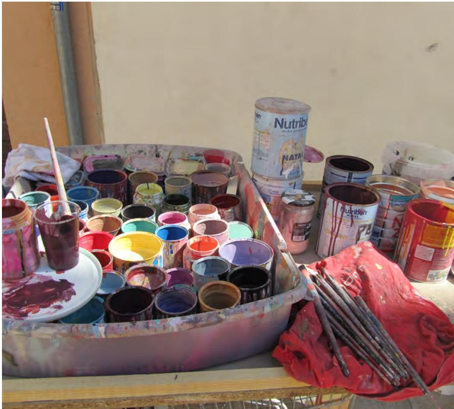
*Envases de pintura abiertos y en zonas no protegidas de la radiación solar directa. INVASSAT*
