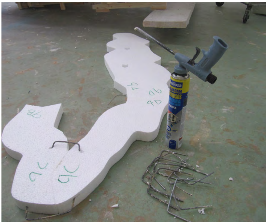
Pegado de los distintos elementos que componen una misma capa, una vez estos han sido cortados. INVASSAT
