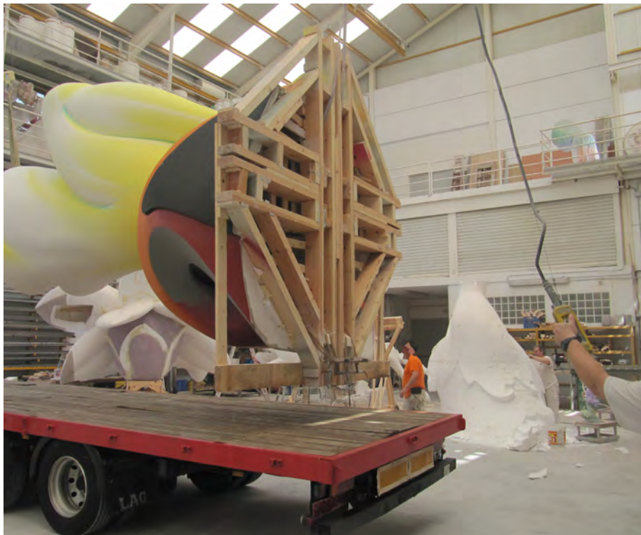
Ejemplo de carga utilizando dos puentes grúa monocarril. INVASSAT
