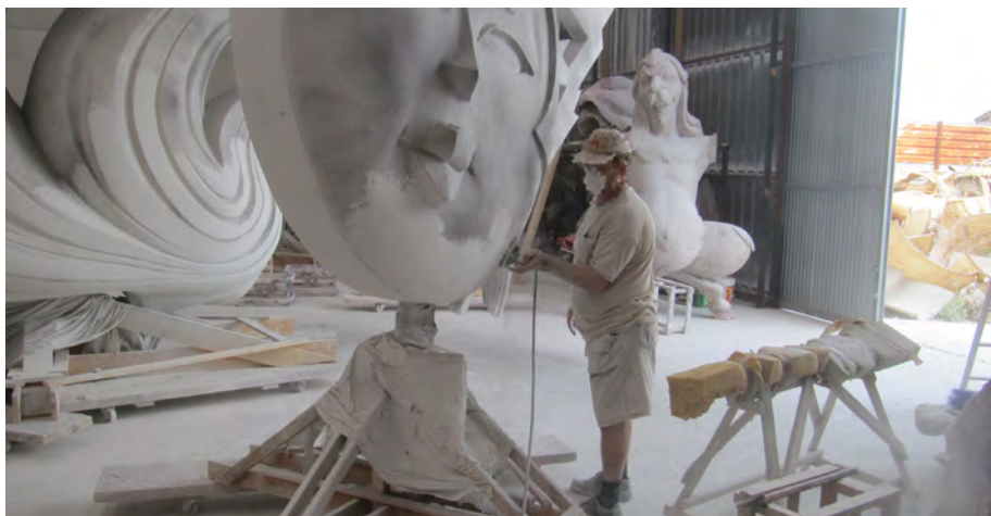
Operación de lijado con herramienta manual eléctrica. INVASSAT
