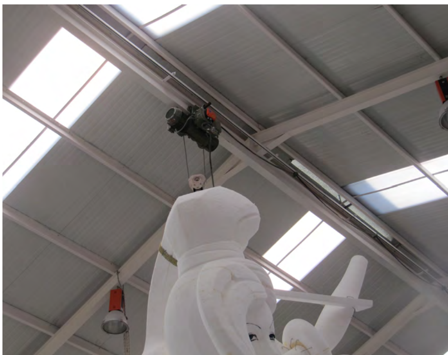
Ejemplo de grúa monocarril. INVASSAT
