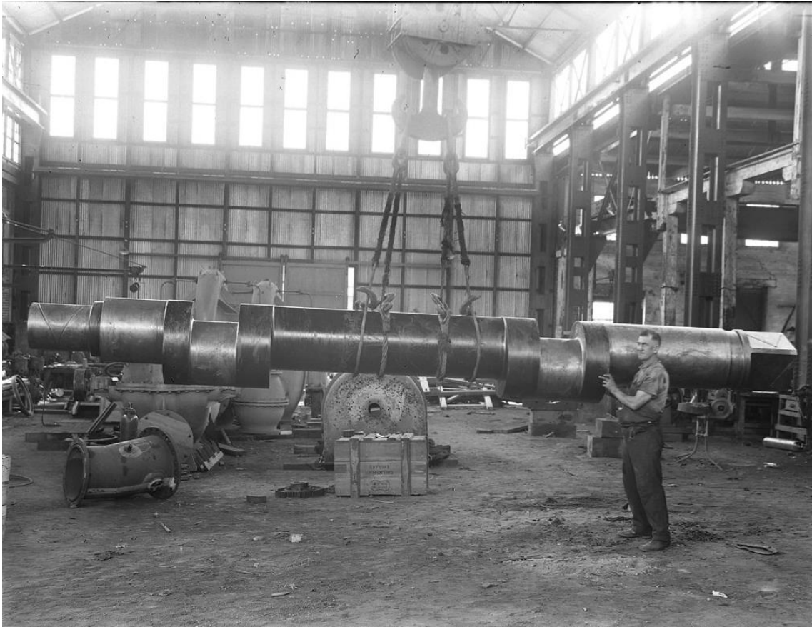
Man with crankshaft forging. 1930-1945. Powerhouse Museum . Document compartit amb llicència Creative Commons BY-NC-ND 4.0 .
