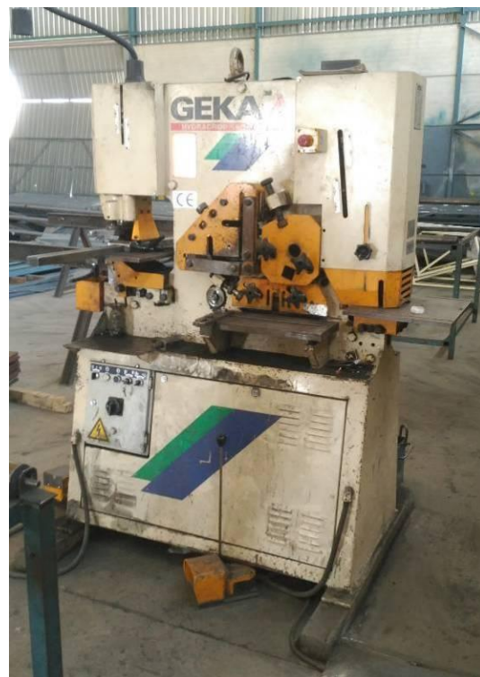
Fotografía 1. Máquina cizalla-punzonadora que originó el accidente
