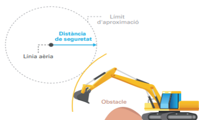
Exemple de mesures preventives en treballs amb màquines a prop de línies aèries
