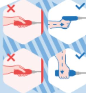
1| Empujadura tipo pistola para trabajos realizados a la altura del codo.
