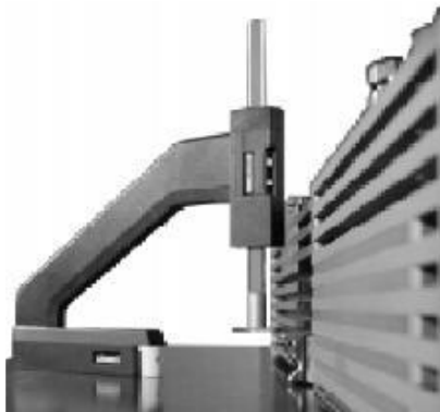
Fotografies 5 i 6. Calibradors de reglatge analògic (esquerra) i digital. (INSTITUTO NACIONAL DE SEGURIDAD E HIGIENE EN EL TRABAJO (España), 2003)
