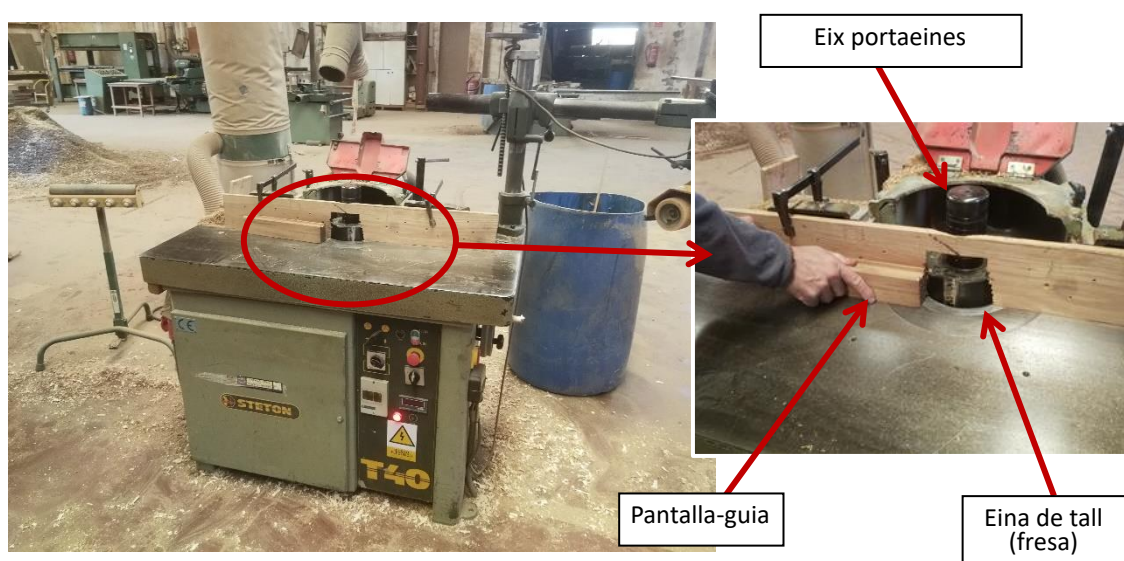
Fotografia 1. Elements de la màquina tupí. INVASSAT
