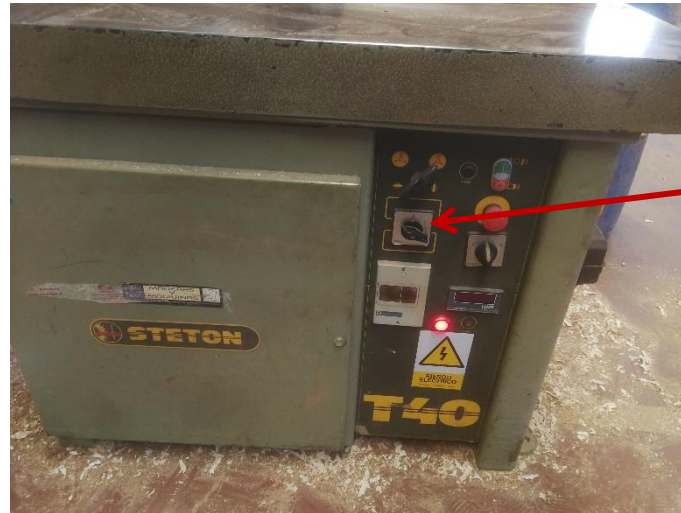
Fotografia 2. Panell de comandament de la màquina tupí. INVASSAT
