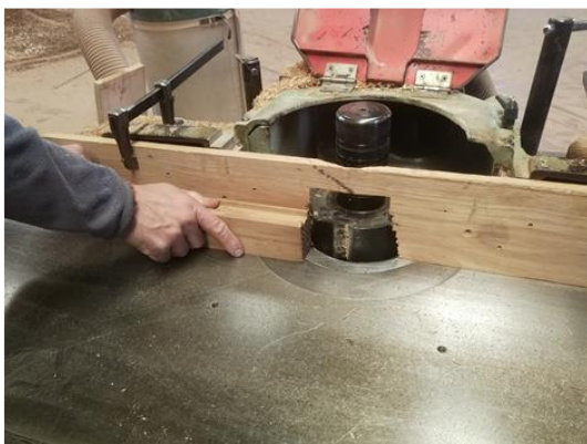
Fotografia 3. Operació de comprovació manual de l'ajust de la fresa. INVASSAT
