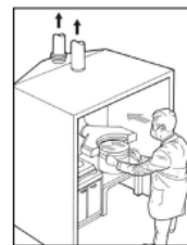
Almacene y prepare los pigmentos y barnices en una cabina con flujo de entrada de aire de entre 1 y 1,5 m/s.
