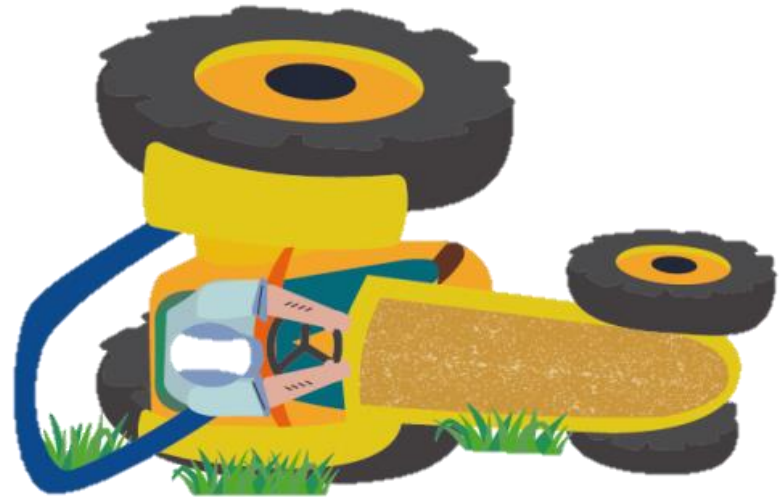
El conductor queda retenido dentro de la zona de seguridad que proporciona la ROPS
