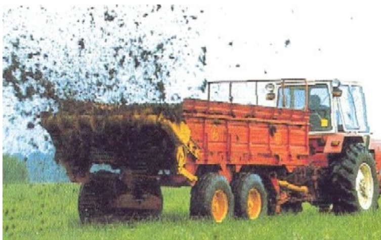
Figura 1: Tractor amb remolc escampador d'abonament acoblat. Font: Ministeri d'Agricultura, Pesca i Alimentació
