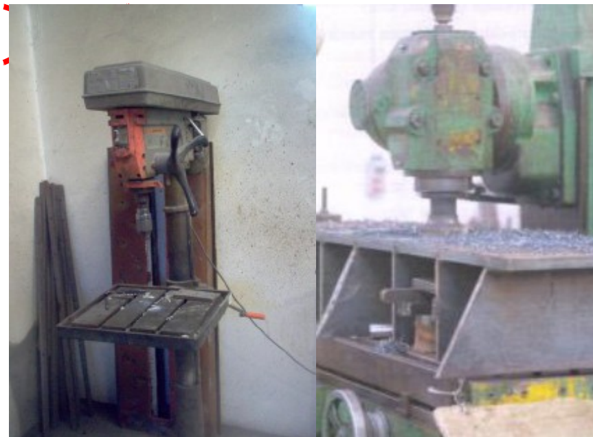
Herramientas (fresa y broca) sin protección
