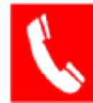
Teléfono para la lucha contra incendios
