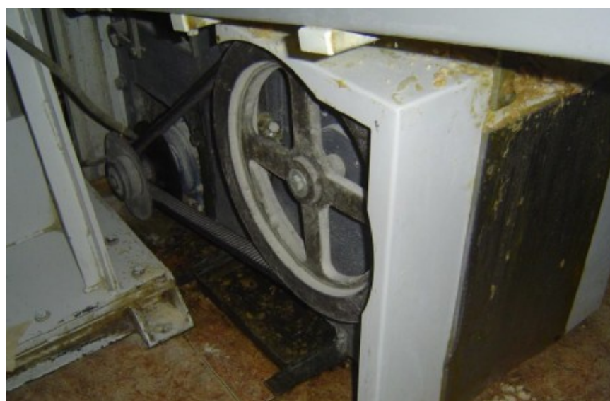
Mecanismo de transmisión correa-poleas sin resguardo protector
