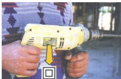
Taladro portátil con doble aislamiento
