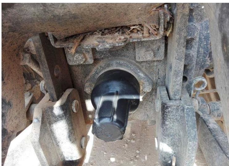
Ilustración 7. Protección de la toma de fuerza. INVASSAT
