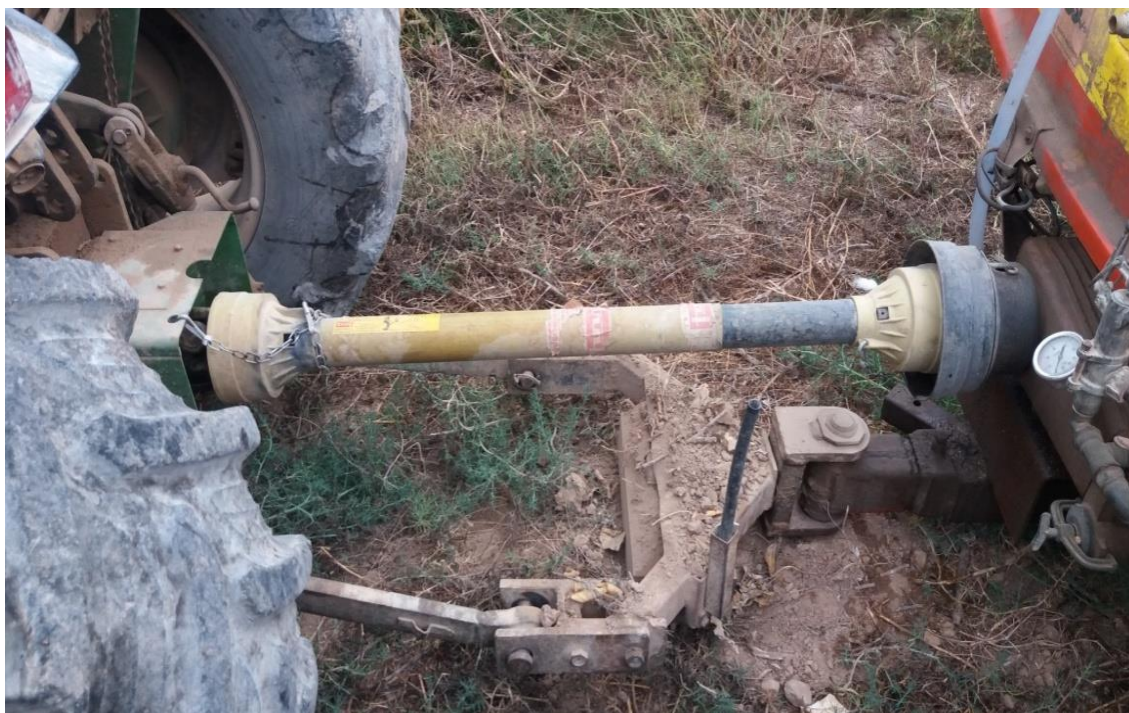
Ilustración 5. Eje cardánico. INVASSAT
