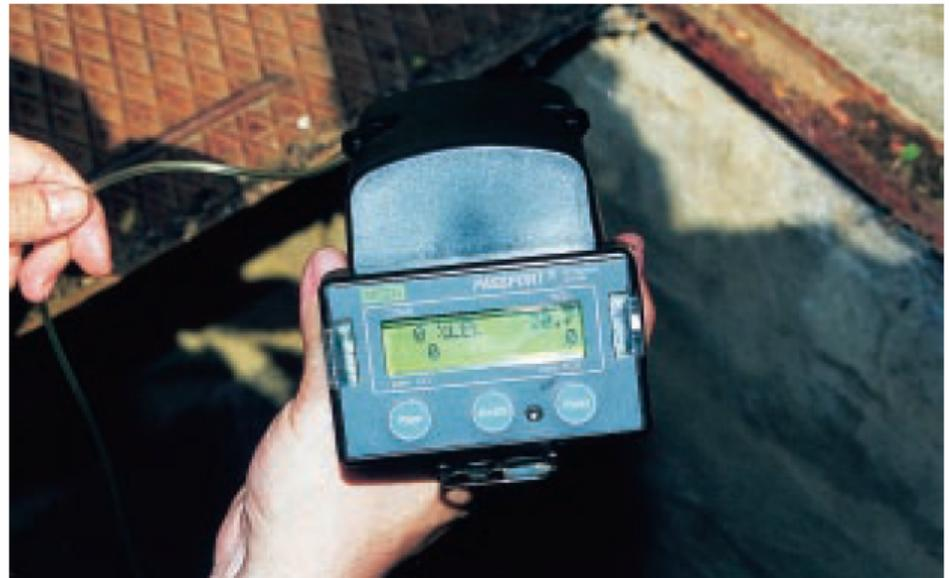
2. Medición simultánea de explosividad, oxígeno, monóxido de carbono y sulfuro de hidrógeno.
