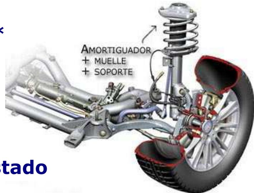
\* *Un amortiguador y el soporte con el muelle*
